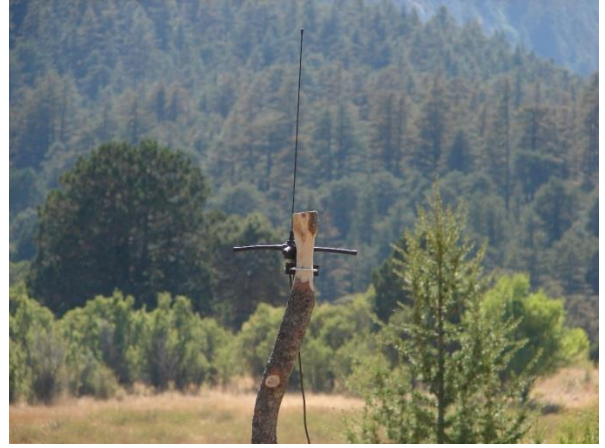
Resim 11. Datalogger anteni Picture 11. Datalogger antenna
