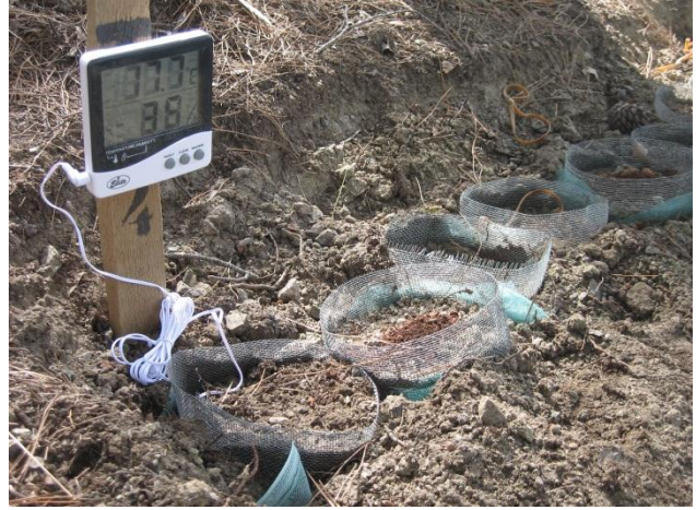
Resim 2: Toprak nem ve sıcaklık ölçer
