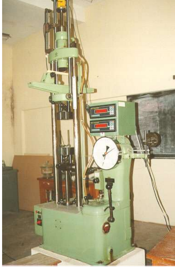
Şekil 3. Deneylerin yapıldığı universal ağaç malzeme test makinası Figure 3. Universal machine used for testing of wood samples
