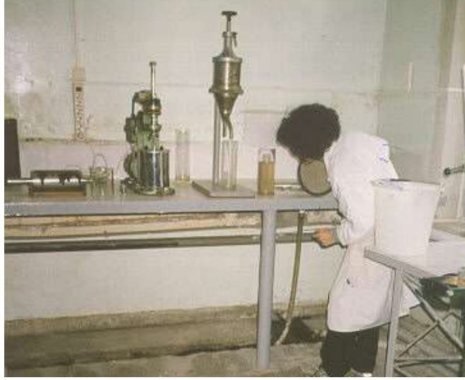
Şekil 5. Hamurların Schopper-Riegler cihazında serbestliklerinin belirlenmesi Figure 5. Determination of freeness (SR 0 ) of pulps with Schopper-Riegler
