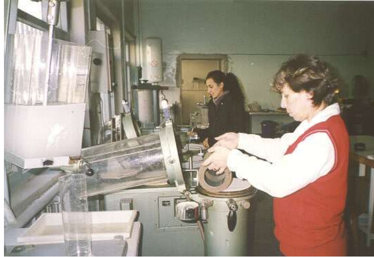
Şekil 9. Taslağın kurutma kısmına aktarılmaya hazırlanması Şekil 9. Preperation of paper samples for drying process
